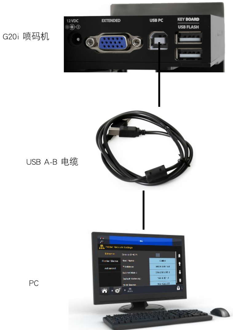
PC 与 G20i 的连接示意图
