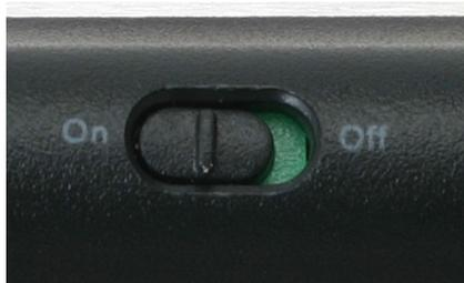
*Interrupteur Marche/Arrêt du clavier USB sans fil*
